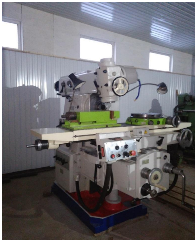
Рисунок 5 – Фрезерный станок 6Т82Ш
