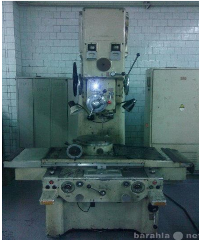
Рисунок 3 – Координатно-сверлильный станок 2E440A
