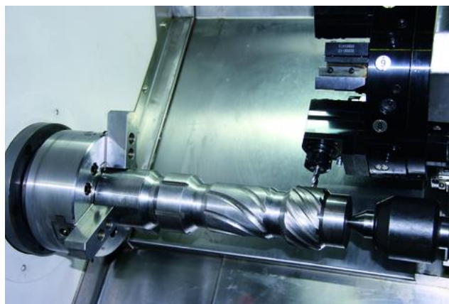
Рисунок 2.10 – Револьверная головка с приводным инструментом и осью «С»
