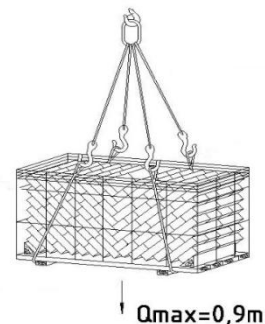
Рис. 3.2 Строповка поддона с кирпичом
