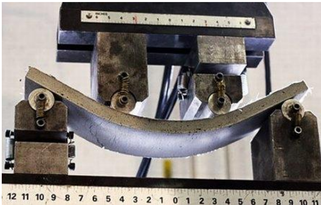
Рисунок 5.6 – Испытания самозалечивающегося эластичного бетон
