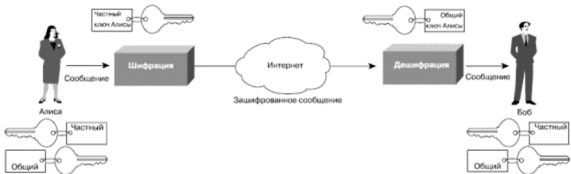
Рисунок 8 – Получение сообщения, с использованием асимметричного шифрования
