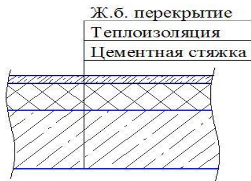
Рисунок 7 – Состав кровли к таблице 5
