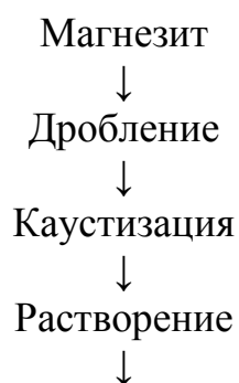
Рисунок 1– Способ обогащения магнезита фирмой «Зульцер Браверс»
