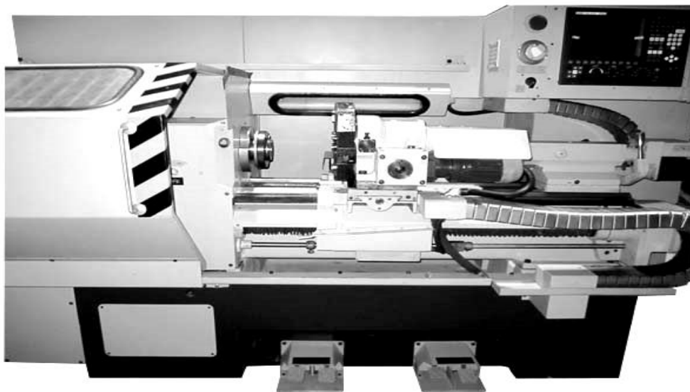
Рисунок 1.2 – Токарно-винторезный станок с ЧПУ модель 16Б16Т1
