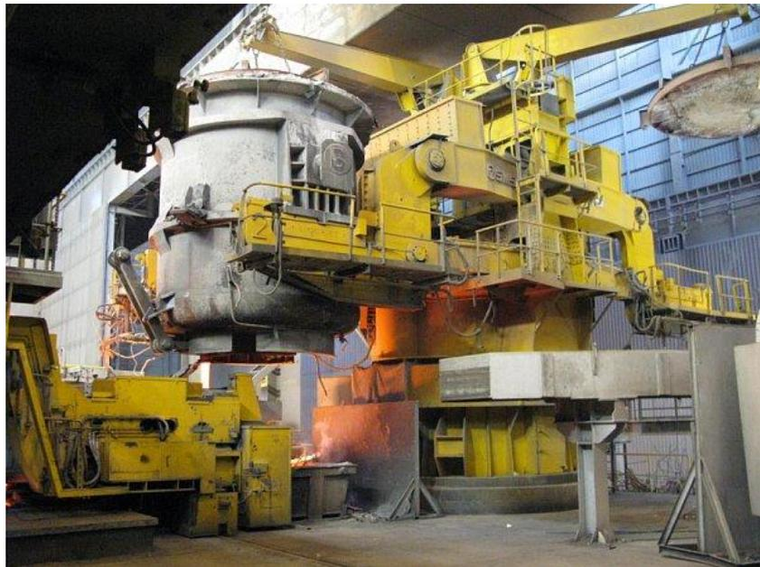
Рисунок 2.2 – Подъемно–поворотный стенд
