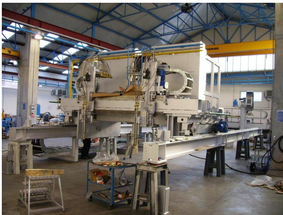
Рисунок 2.6 – Общий вид машины газокислородной резки
