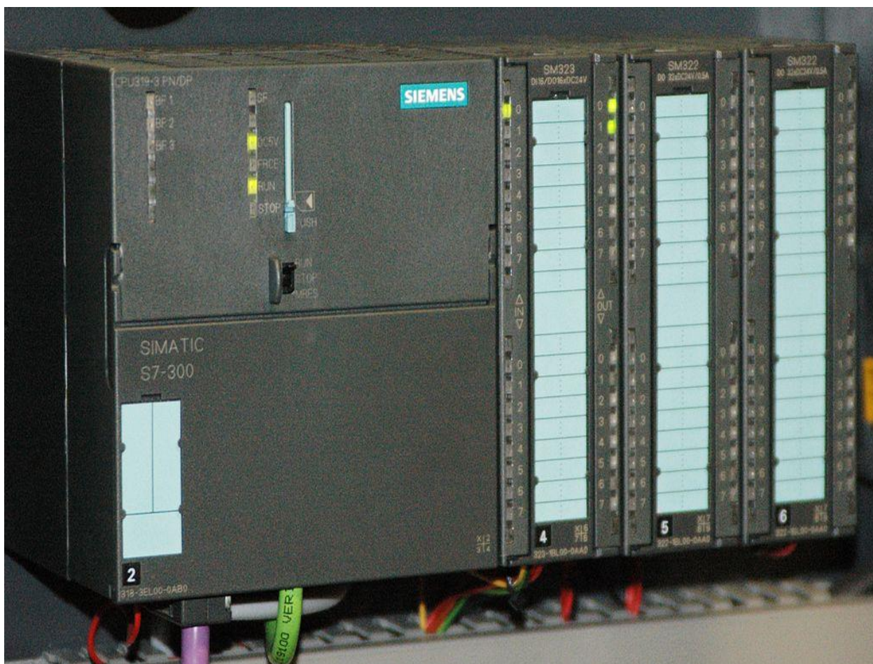
Рисунок 3.20 – Программируемый логический контроллер SIMATIC S7-300
