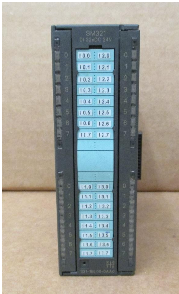
Рисунок 3.21 – Модуль ввода дискретных сигналов SM 321
