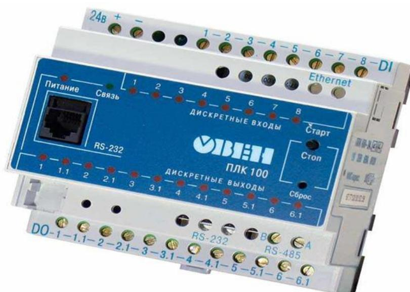
Рисунок 3.4 - Промышленный контроллер ПЛК-100
