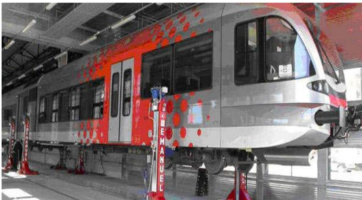
Рисунок 3.6 - Поднятие трёхсекционного шестиосного трамвайного вагона модели 71-631
