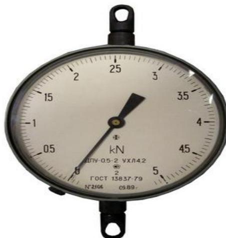
Рисунок 3.22 Динамометр механический ДПУ-5 общего назначения
