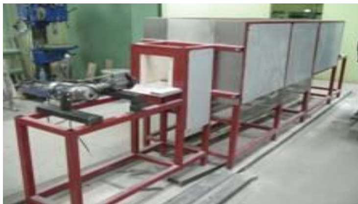
Рисунок 1.5 - Туннельная электропечь ТК.82.1300.3Ф
