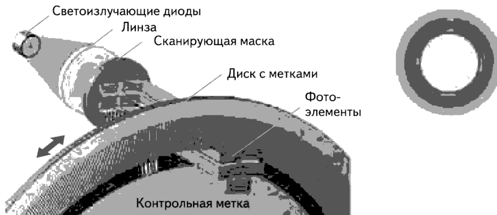
Рисунок 4.10- Конструкция стандартного оптического энкодера
