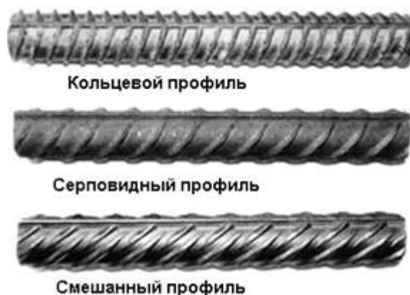
Рисунок 1.4 – Тип профиля арматуры
