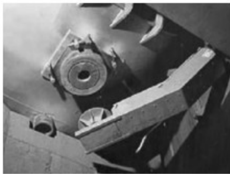
Рисунок 1.6 — Эркерный выпуск жидкого металла
