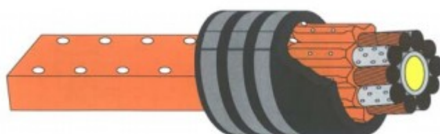
Рисунок 1.5 — Гибкие водоохлаждаемые кабели
