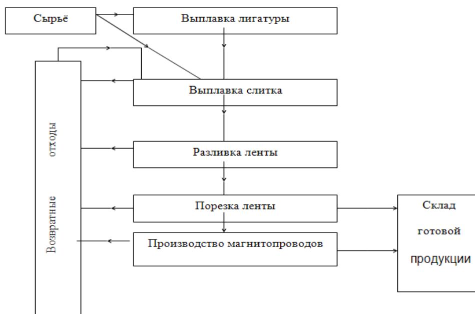
Рисунок 3 – Технологическая схема производства аморфной ленты и магнитопроводов в ЭСПЦ-1
