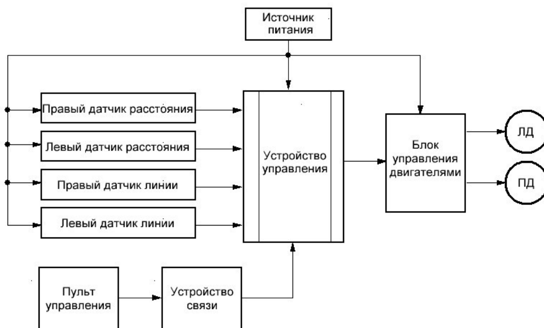
Рисунок 2.2 – Функциональная схема электропривода
