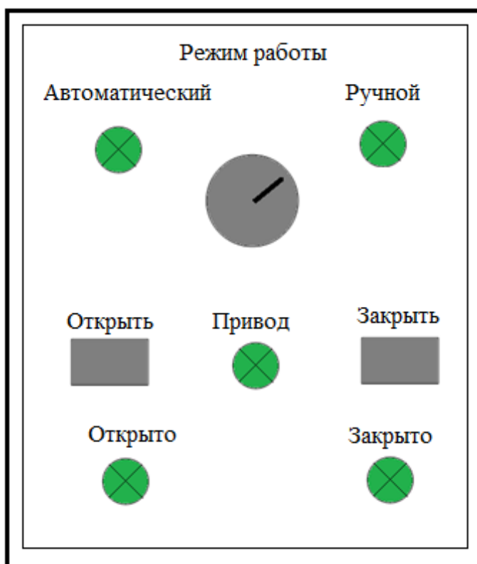
Рисунок 4.2 – Общий вид пульта управления шлагбаумом
