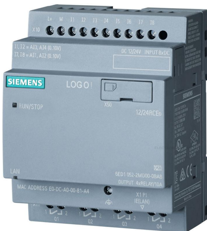
Рисунок 7.1 – Контроллер Siemens LOGO!8 PURE 12/24RCEo
