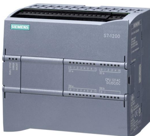
Рисунок 6.1 – Внешний вид ПЛК Siemens SIMATIC S7-1200
