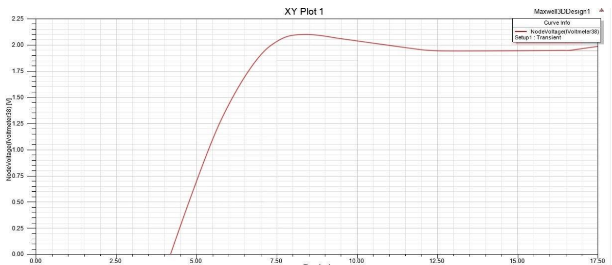
Рисунок 2.13 – Напряжение на выходном вольтметре для кольцевого однополюсного МД
