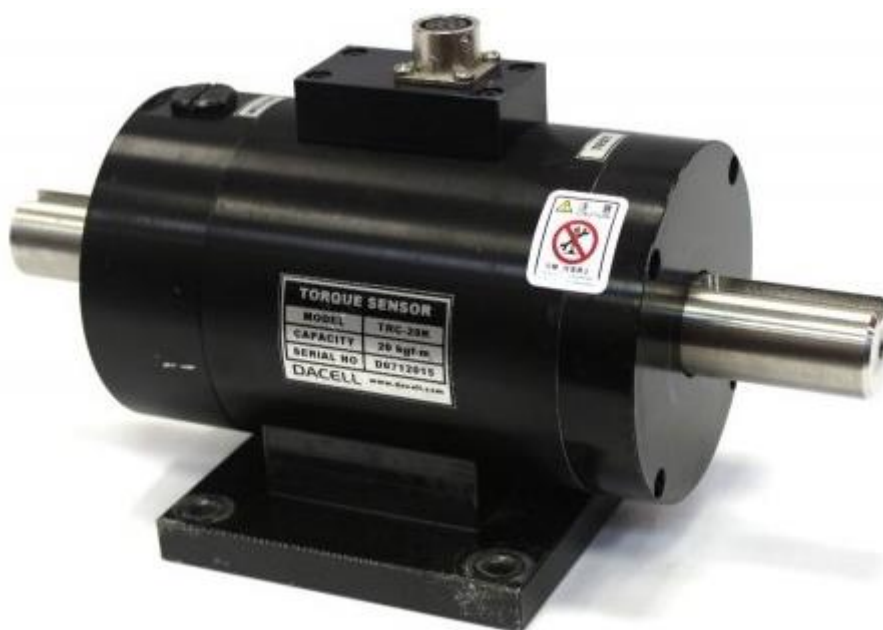
Рисунок 4.7 – Тензометрический датчик TRC-200K
