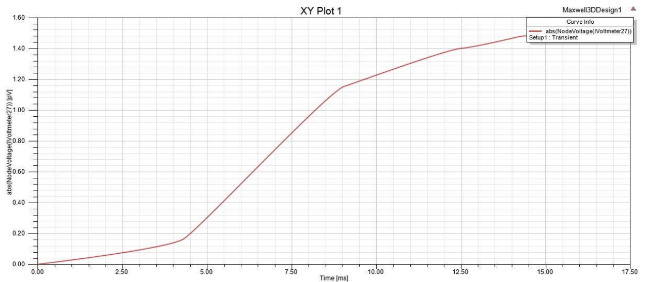
Рисунок 2.12 – Напряжение на выходном вольтметре для крестового МД с удвоенным количеством измерительных полюсов
