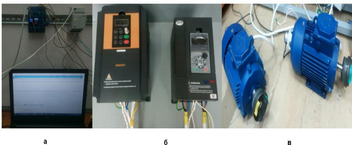
Рисунок 5.1 – Стенд для снятия экспериментов: а - ПЛК, ПК и блок питания; б – преобразователи частоты; в - электродвигатели
