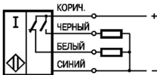
Рисунок 19 – Схема подключения датчика ВБИ-Φ80-40К-2183-С.9.18
