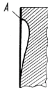
Рисунок 1.4 - Характер изнашивания зеркала цилиндра ДВС.
