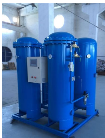
Рисунок 2.5 – Адсорбционный генератор азота со встроенным адсорбционным осушителем.
