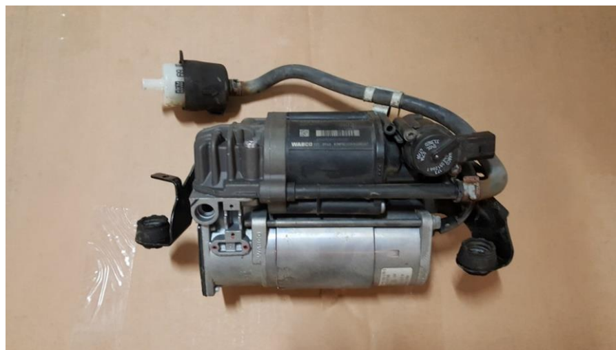
Рисунок 2.1 – Компрессор поршневой для пневмоподвески автомобиля
