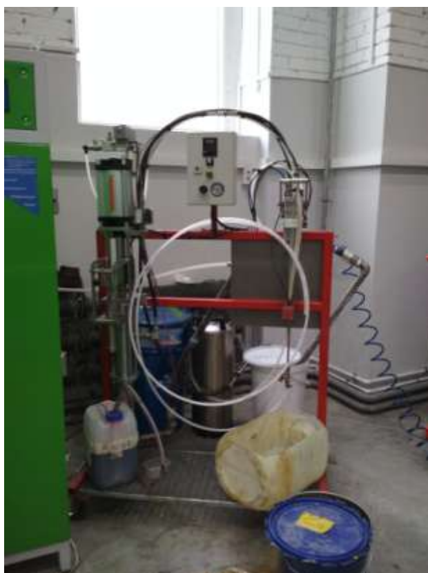
Рисунок 6 – Установка литья под давлением полиэфирной смолы Wolfangel - Polyester Resin Injection Plant
