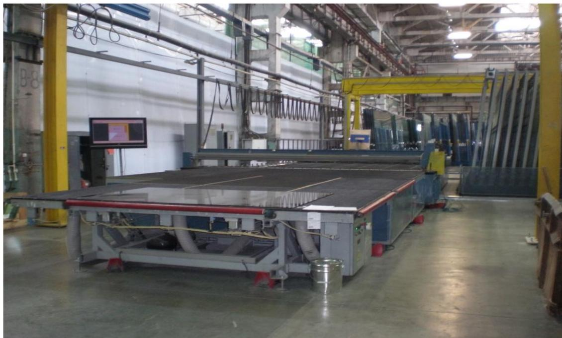
Рисунок 1– Стол резки Lisec GFB 60/30RE
