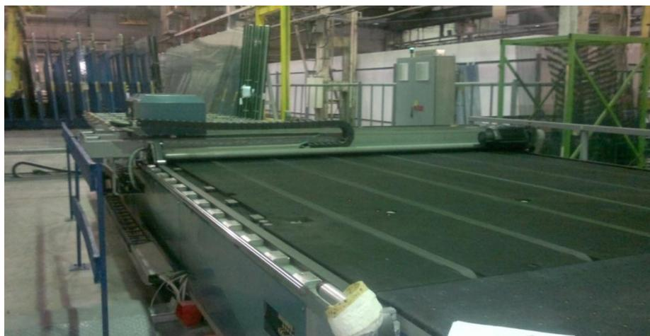
Рисунок 3 – Стол резки Lisec ESL 60/30 RS
