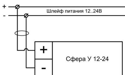
Рисунок 4.11 – Схема подключения
