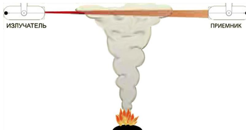
Рисунок 3.4 – Принцип работы линейного извещателя
