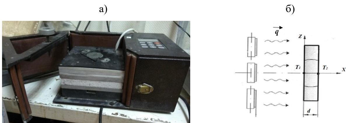
Рисунок 21 – Измеритель теплопроводности ИТС-1: а) прибор с образцом для испытаний; б) схема принципа действия прибора
