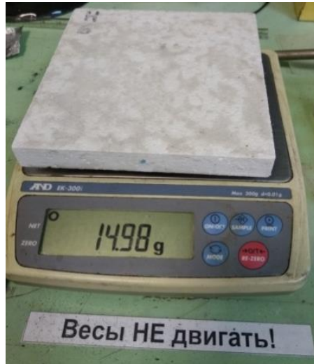
Рисунок 21 – Взвешивание образцов после водопоглощения
