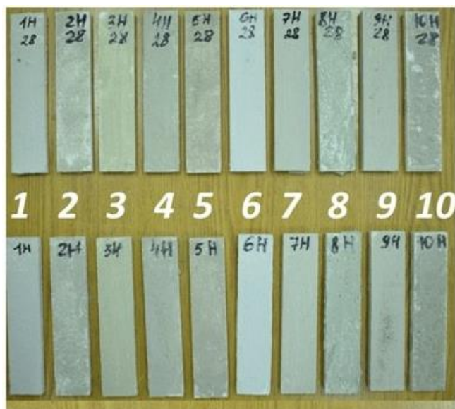
Рисунок 13 – Образцы ППС после покрытия и сушки
