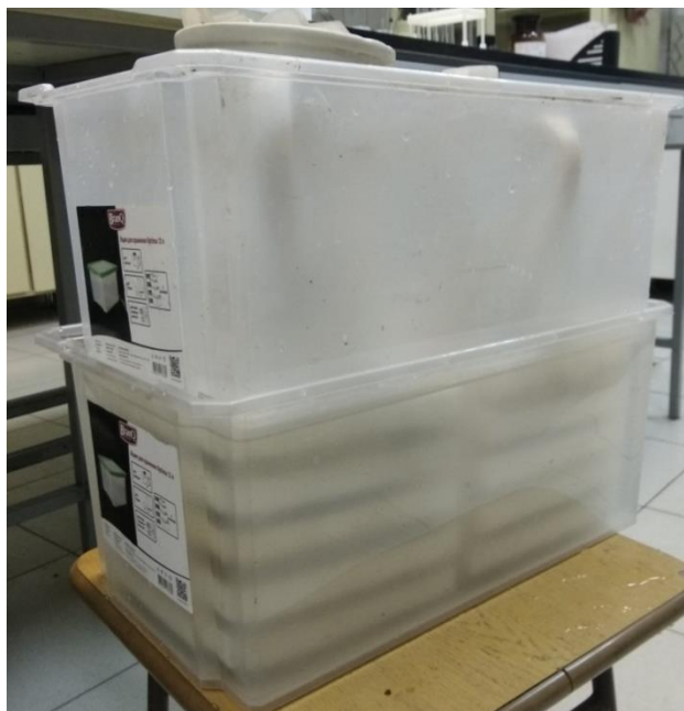
Рисунок 20 – Ванна с образцами и дистиллированной водой для определения водопоглощения
