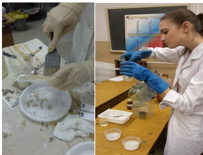
Рисунок 11 – Обработка образцов огнезащитными составами
