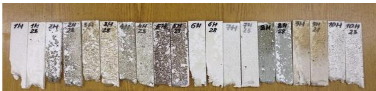
Рисунок 14 – Степень выгорания образцов
