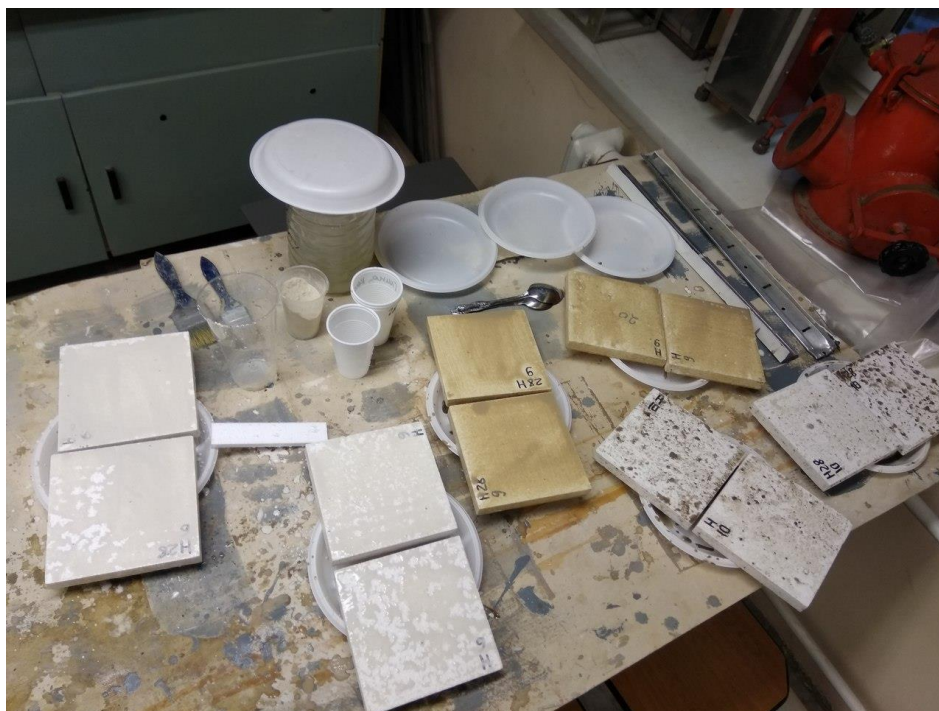
Рисунок 17 – Обработанные составами образцы ППС
