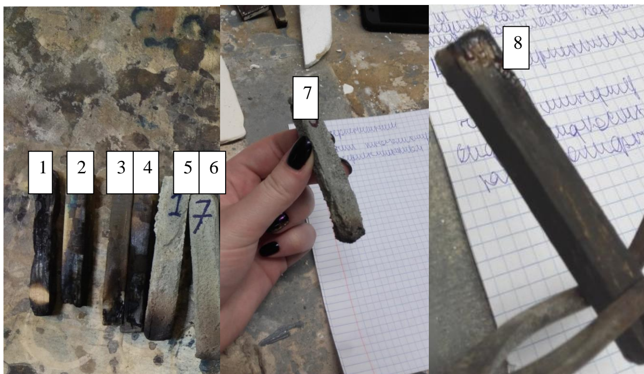
Рисунок 20 – Образцы древесины после огневого испытания
