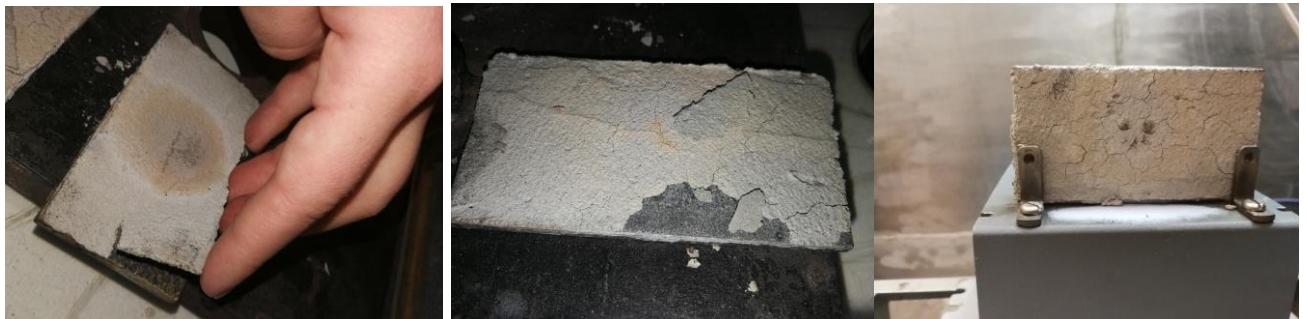
Рисунок 18 – образцы металла, обработанные огнезащитным составом № 2 после огневого испытания:
