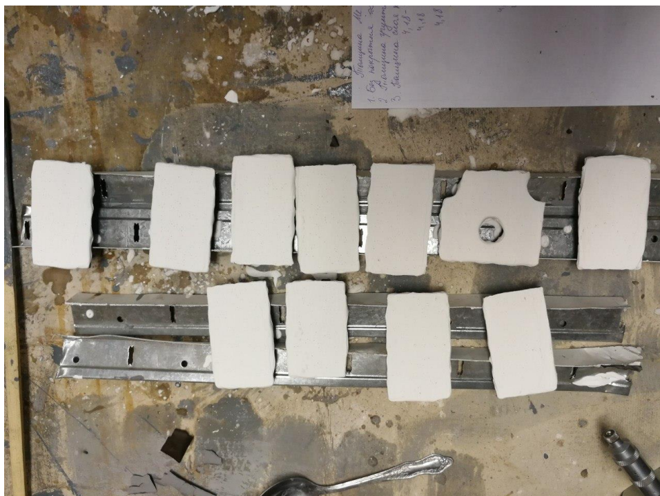
Рисунок 6 – Внешний вид образцов металла, обработанных огнезащитным средством № 3
