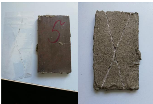
Рисунок 10 – Адгезионные свойства огнезащитного покрытия № 2 после воздействия
