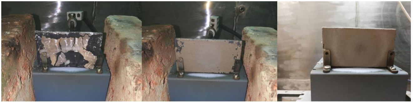
Рисунок 17 – Образцы металла, обработанные огнезащитным составом № 1 после огневого испытания:
