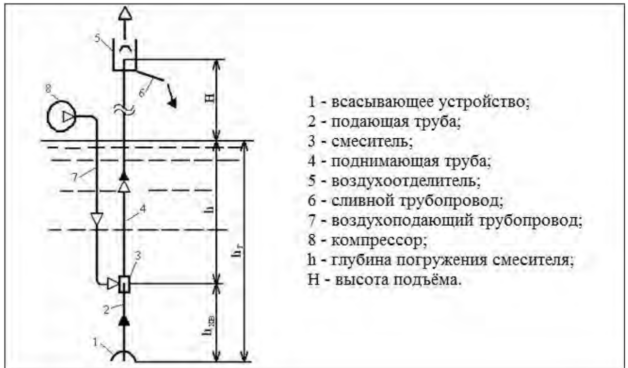
Рисунок -2 Схема эрлифта
