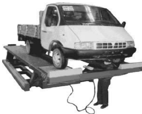
Рисунок 2.6 – Люфт-детектор, смонтированный на подъемнике
