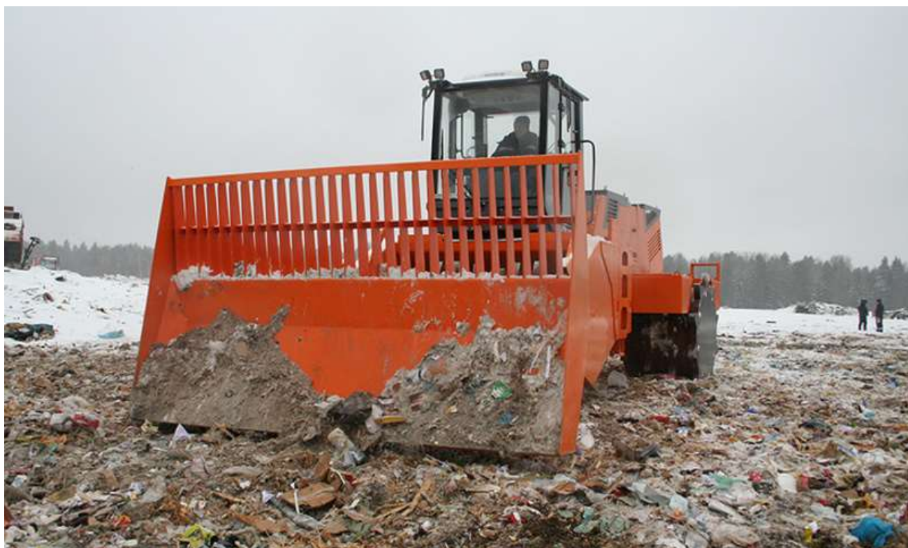
Рисунок 1.8 – Компактор «Бурлак» с специальным отвалом
