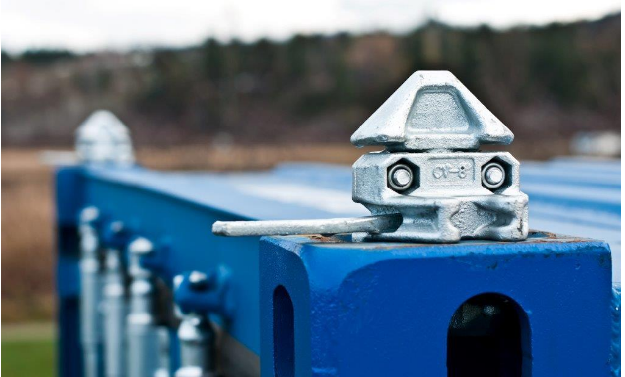
Рисунок 8 – Поворотная цапфа не утопленная
