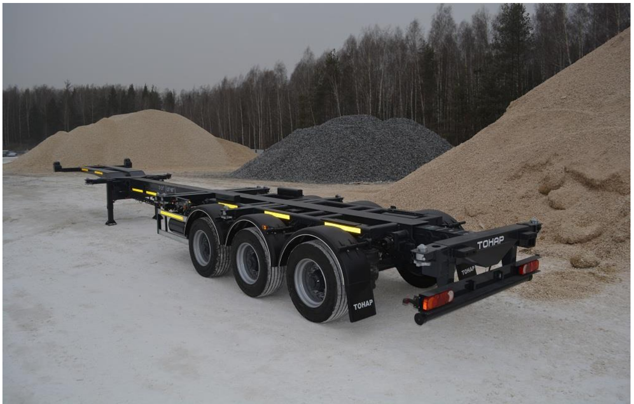
Рисунок 1 – Раздвижной полуприцеп-контейнеровоз Тонар-974629
