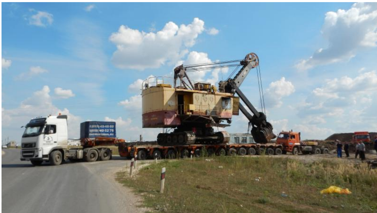
Рисунок 5 – Перевозка с помощью самоходных модулей
