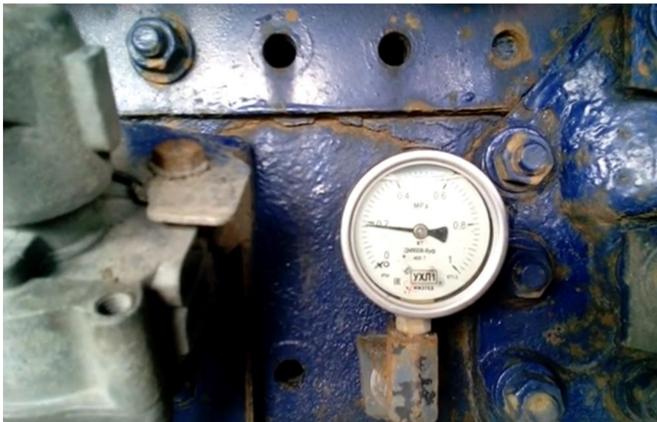
Рисунок 24 – Установка и показание манометра на тягаче без нагрузки на ССУ
