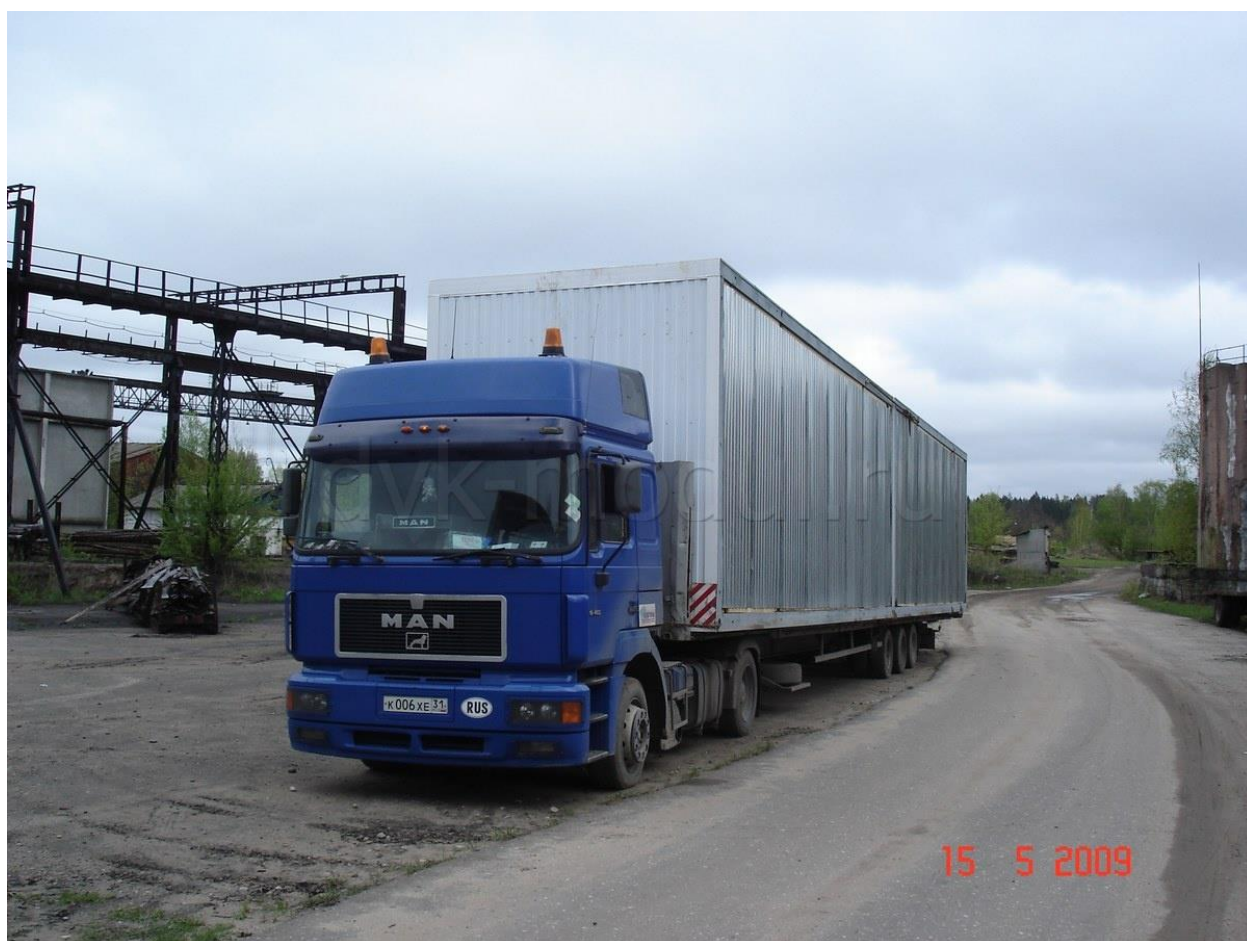
Рисунок 4 – негабаритная перевозка на полуприцепе-контейнеровозе
