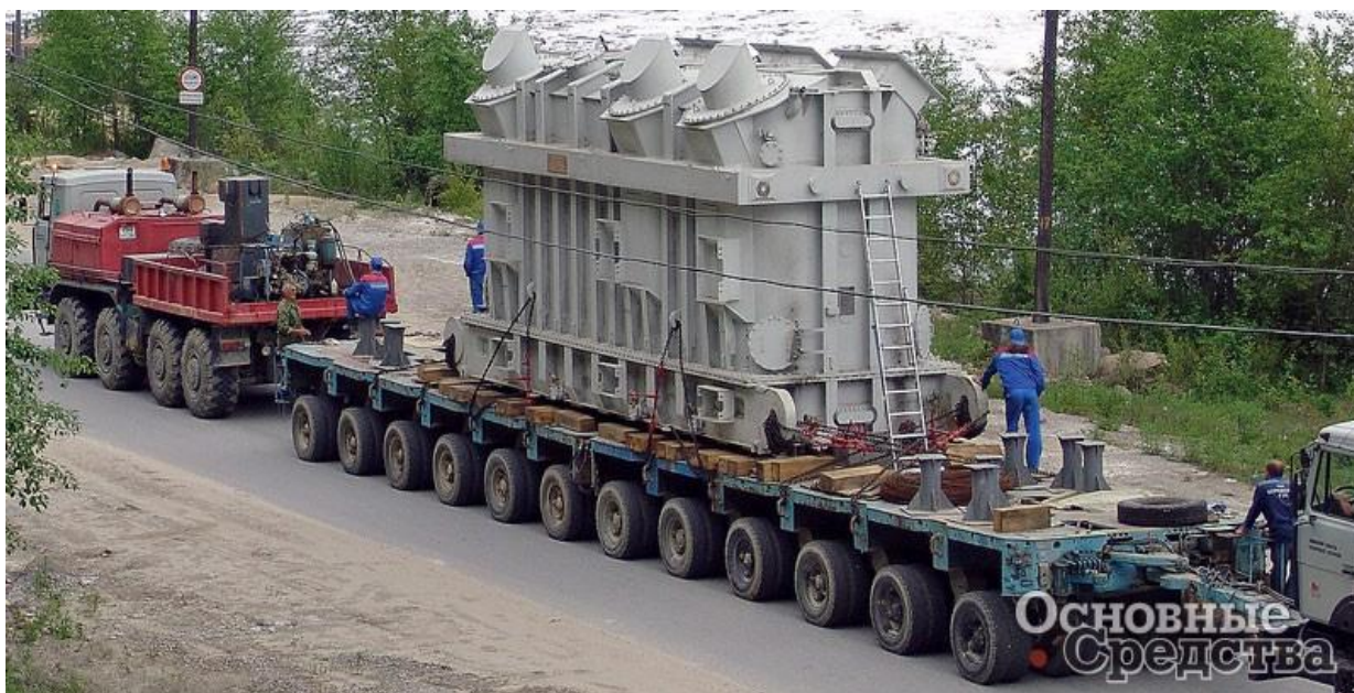
Рисунок 6 – Транспортировка трансформатора для Бурейской ГЭС на модульном полуприцепе ЧМЗАП 706010
