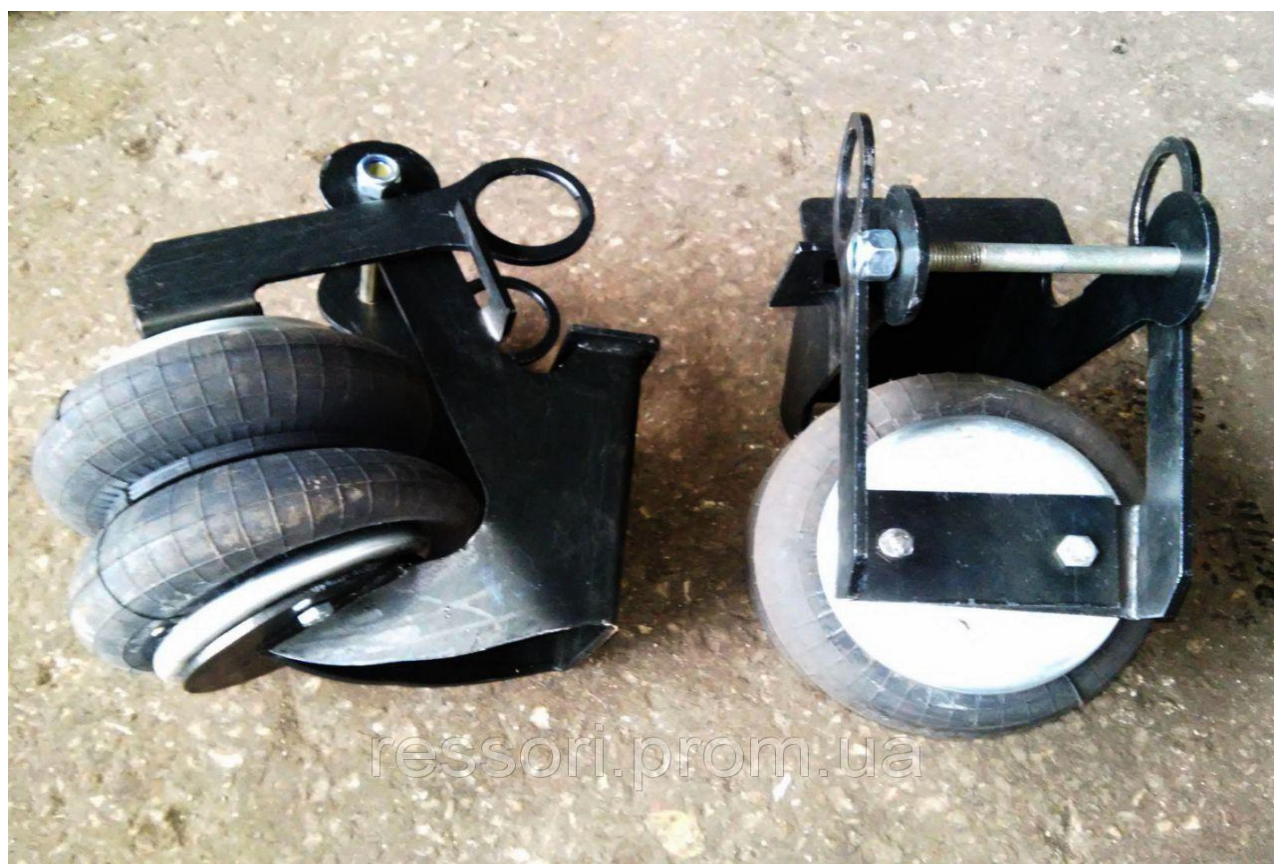
Рисунок 28 – Крепление подъемной оси Weweler AL-460
