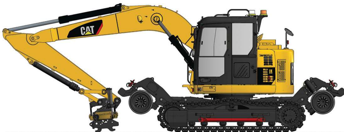
Рисунок 1.4 –Экскаватор на комбинированном ходу Railmax RMT15F
