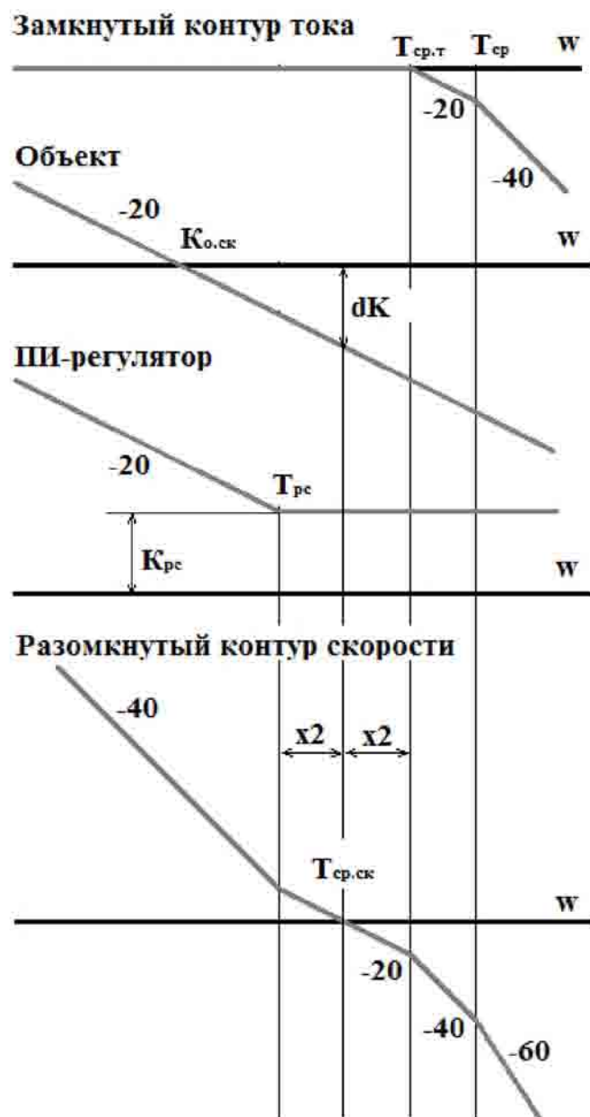
Рисунок 3.7 – АЧХ звеньев контура скорости
