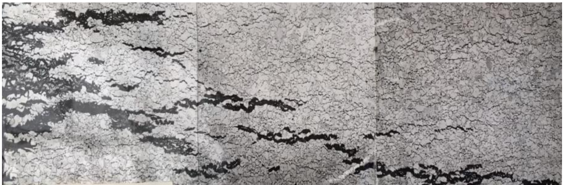
Рисунок 14 – Гиб паропровода, разрушенный по механизму ползучести: а – общий видгиба; б – макротрещины ползучести в сопровождении микротрещин и множественных цепочек пор в микроструктуре разрушенного гиба, x100
