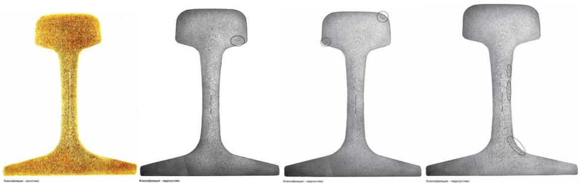
изображение (13) допустимая ликвационная полоска (14-16) недопустимая ликвационная полоска [2, 11].
