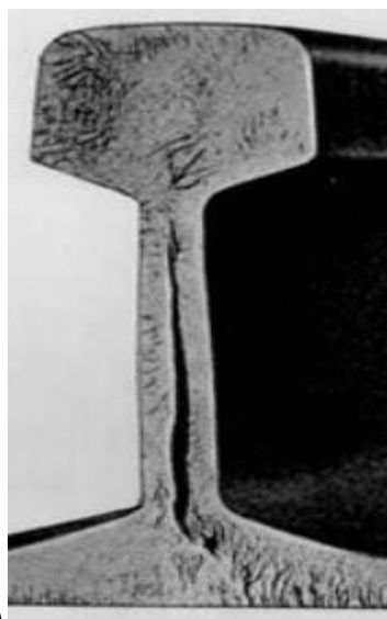
Рисунок 19 – дефекты выявляемые по средствам неразрушающего контроля а, б) продольные и поперечные трещины головки, в) вертикальное расслоение шейки
