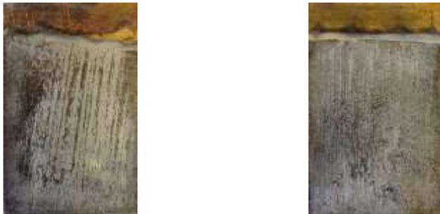
г)  $i = 2,5$  A/dm<sup>2</sup>,  $T = 20$  °C   д)  $i = 3,0$  A/dm<sup>2</sup>,  $T = 20$  °C
