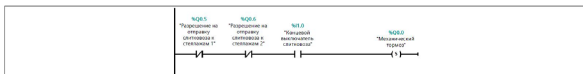
Network 2: Остановка слитковоза, наложение механического тормоза на его двигатель
