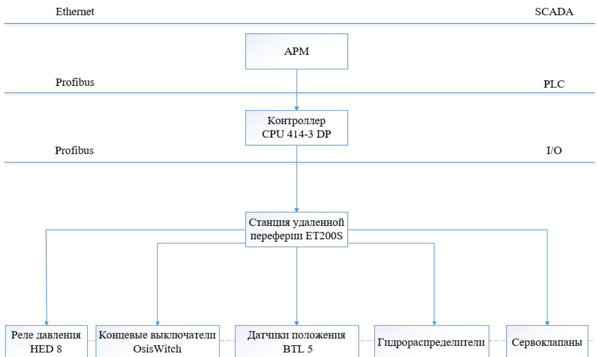
Рисунок 2.1– Архитектура системы автоматизации зажимного устройства
