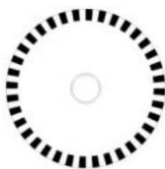
Рисунок 8 – Диск с метками оптического инкрементального энкодера
