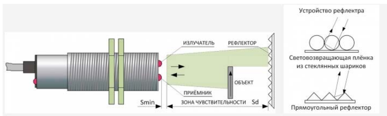
Рисунок 10 – Принцип работы рефлекторного оптического датчика
