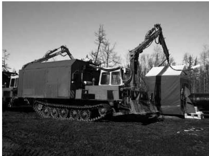
Рисунок 1.16 – Общий вид сварочного агрегата в монтажном положении
