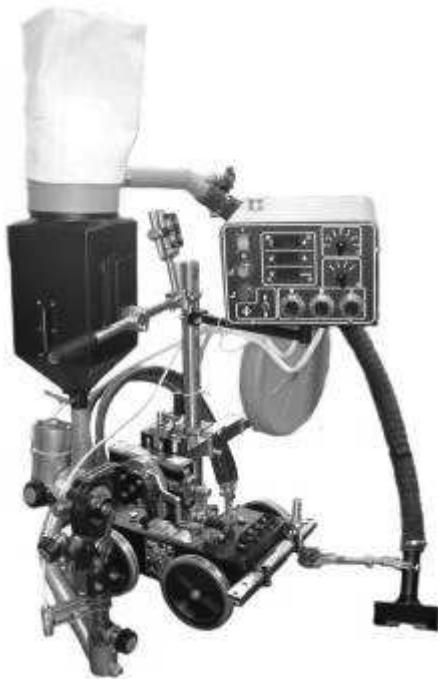
Рисунок 1.18 – Общий вид сварочного трактора АДФ-1000
