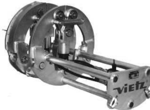
Рисунок 2.1 – Общий вид центратора
