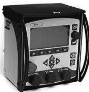
Рисунок 1.10 – Общий вид контроллера EsabPEK
