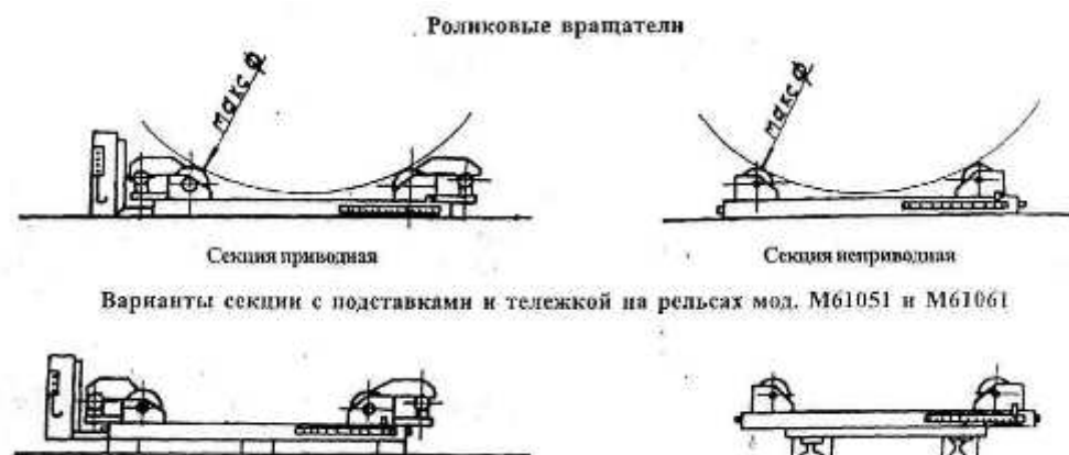
Рисунок 2.15 – Роликовые вращатели М61061
