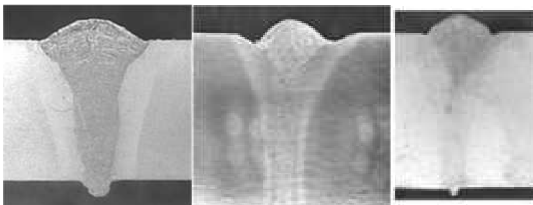
Рисунок 3.7 – Сварные швы, полученные при разных режимах сварки.
