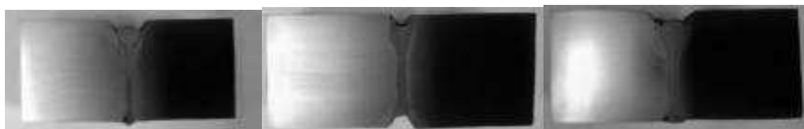
Рис. 3.22 – Шлифы сварных швов, полученных согласно полученным зависимостям
