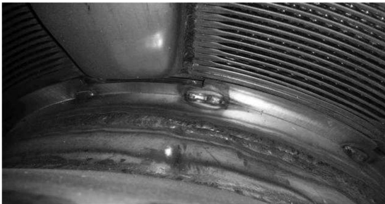
Рисунок 2.1 – Сварной шов теплообменника
