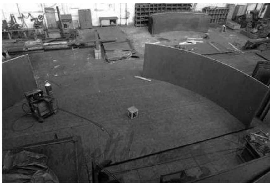
Рисунок 2.4 – Контрольная сборка днища с выставлением пояса полотнища стенки
