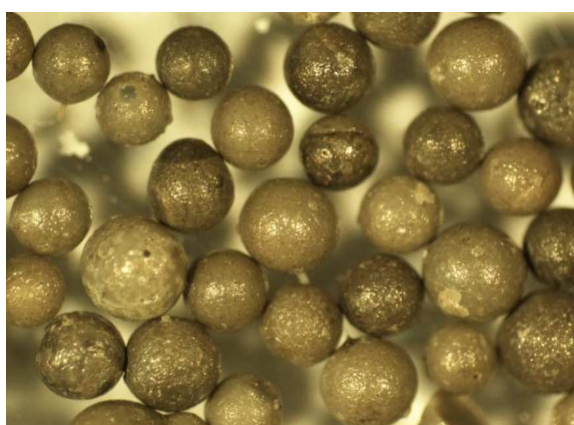
Рисунок 3.3. – Пропанты фракции 0,63...1 мм (x 25) и диаграмма Крумбьена – Шлосса для визуального определения сферичности и округлости
